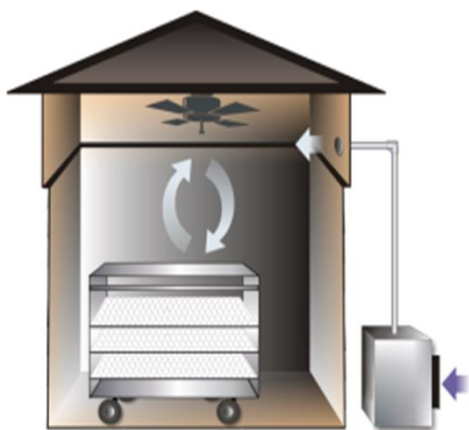
Hình 8. 10. Thiết bị tạo sương mù ozone dùng để thanh trùng bề mặt trứng. Hệ thống này phản ứng ozone với hơi nước để tạo ra các gốc oxi hóa mạnh. Về tổng thể hệ thống này tạo ra chất hóa học tự do và hiệu quả trong việc tiêu diệt vi khuẩn, virus lắng đọng trên vỏ trứng.
