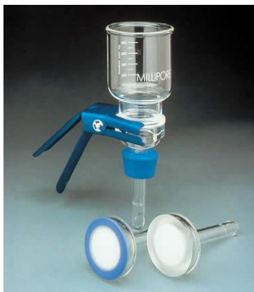
Hình 8.4. Minh họa về bộ lọc nước đơn của hãng Merk - Millipore thường được sử dụng trong phòng thí nghiệm.
