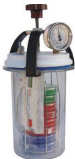
Hình 9.2. Minh họa về bình nuôi cấy kỵ khí theo phương pháp McIntosh – Fildes.
